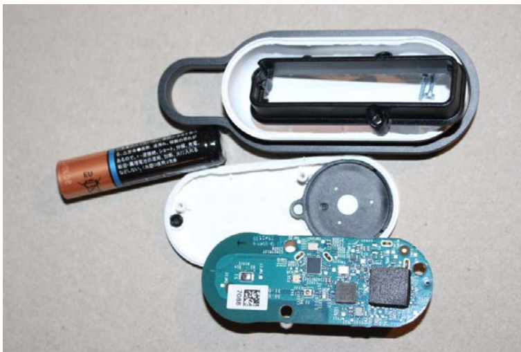
Abbildung 3-8: Einzelteile eines WLAN-Schalters (Amazon Dash Button)
